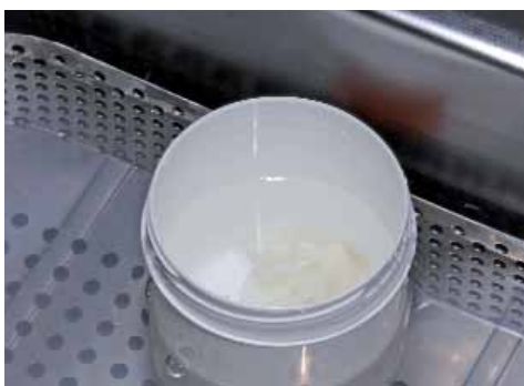
Remover a camada de reação, formada sobre os objetos injetados, usando o Invex Liquid em banho de ultra-som.
