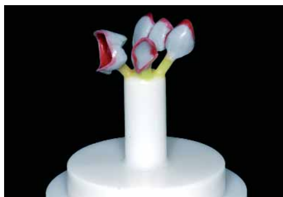
A colocação dos sprues é conduzida sobre a base do anel de revestimento. Os sprues são fixados na direção de escoamento do material cerâmico e sempre na parte mais grossa das restaurações.
