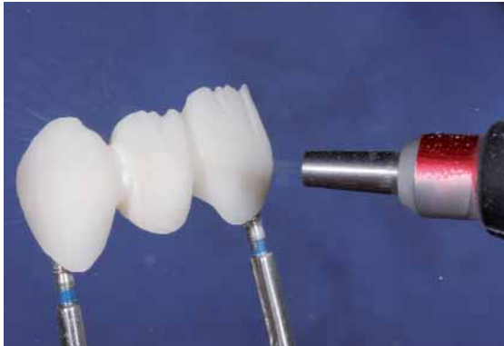
Jatear a restauração com \text{Al}_2\text{O}_3 (Type 100) e pressão de 1 bar (15 psi). Antes da queima de "wash", limpar totalmente a restauração com jato de vapor e secar
