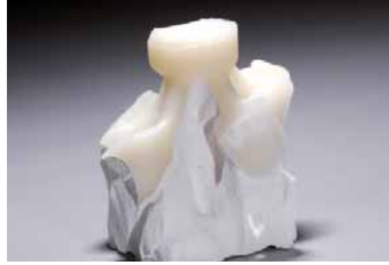
A remoção final do revestimento é realizada com pérolas de vidro para polimento e com 2 bar (30 psi) de pressão.
