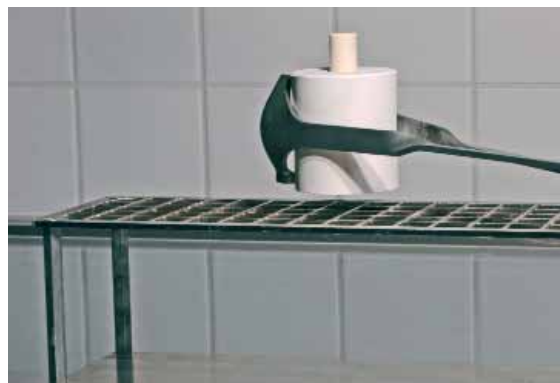
Após o término do programa de injeção, remover o anel de revestimento do forno, usando pinças de revestimento, colocar sobre uma grade de esfriamento e deixar esfriar até a temperatura ambiente.
