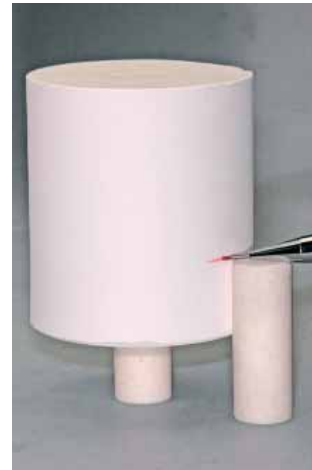
Marcar o comprimento da haste de êmbolo Alox.
