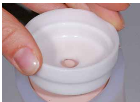
Preencher o anel com revestimento até a marcação e posicionar o anel calibrador com um movimento giratório.
