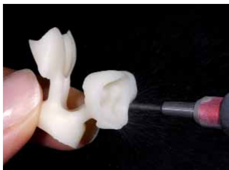
Remover completamente a camada de reação das superfícies de contacto, usando Al_2O_3 (tipo 100) com 1-2 bar (15-30 psi) de pressão.
