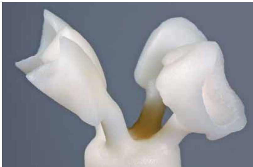
Objetos IPS e.max Press já desincluídos, exibindo leve camada de reação.
