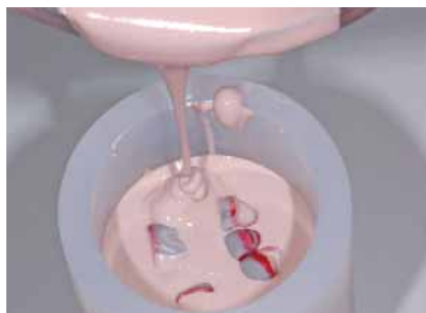
Usar o IPS Silicone Ring para incluir. Vazar o revestimento lenta e cuidadosamente.
