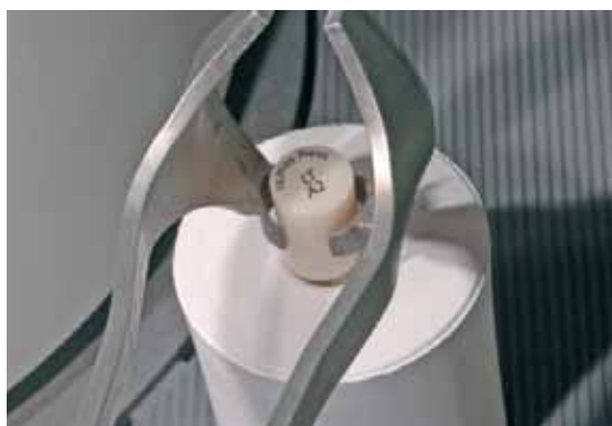
Inserir a fria pastilha IPS e.max Press no quente anel de revestimento, com a designação da cor voltada para cima.
