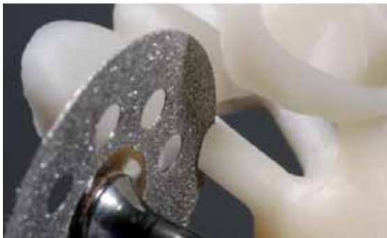
Cortar os sprues, usando discos finos de diamante.
