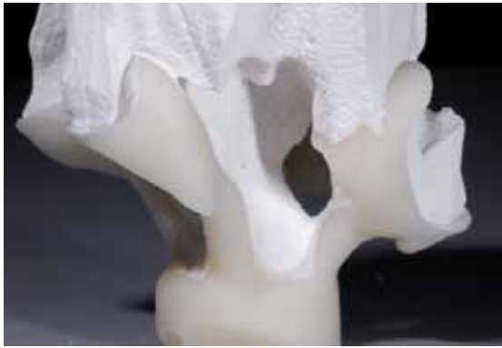
A remoção final do revestimento é realizada com pérolas de vidro para polimento e com 2 bar (30 psi) de pressão.
