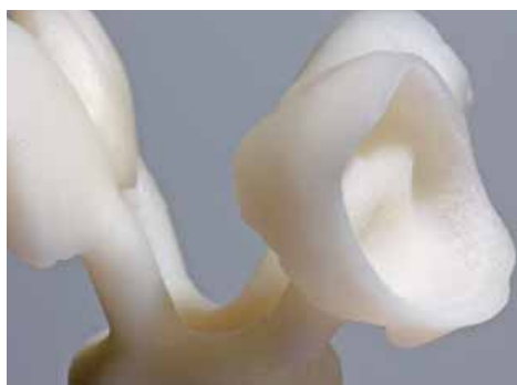
Remover a camada de reação, formada sobre os objetos injetados, usando o Invex Liquid em banho de ultra-som.
