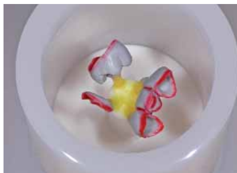
Usar o IPS Silicone Ring para incluir. Vazar o revestimento lenta e cuidadosamente.
