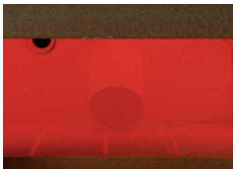
Colocar o anel (cilindro) de revestimento próximo da parede posterior, inclinado e com a abertura voltada para baixo.
