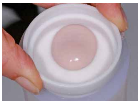
Preencher o anel com revestimento até a marcação e posicionar o anel calibrador com um movimento giratório.
