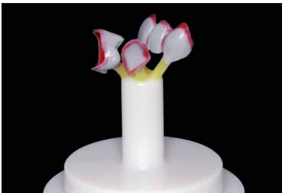
Ceroplastia terminada e posicionada no sistema de anel de inclusão IPS e.max de 200 g.
