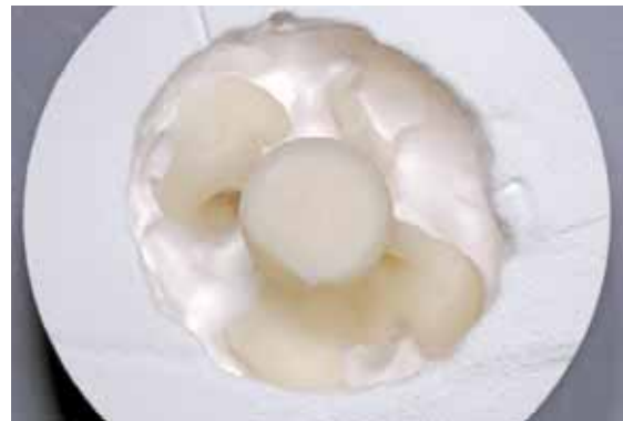
A remoção mais grosseira do revestimento é feita por jateamento, com pérolas de vidro para polimento e com 4 bar (60 psi) de pressão, até que os objetos possam ser visíveis.
