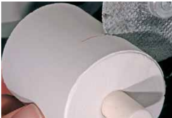
Separar o anel de revestimento com um disco e quebrar através da zona de ruptura pré-determinada.
