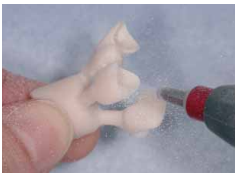
Remover completamente a camada de reação das superfícies de contacto, usando Al_2O_3 (tipo 100) com 1-2 bar (15-30 psi) de pressão.
