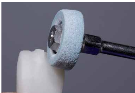
Alisar os pontos de fixação dos sprues, com baixa velocidade e leve pressão, e efetuar o acabamento das superfícies.
